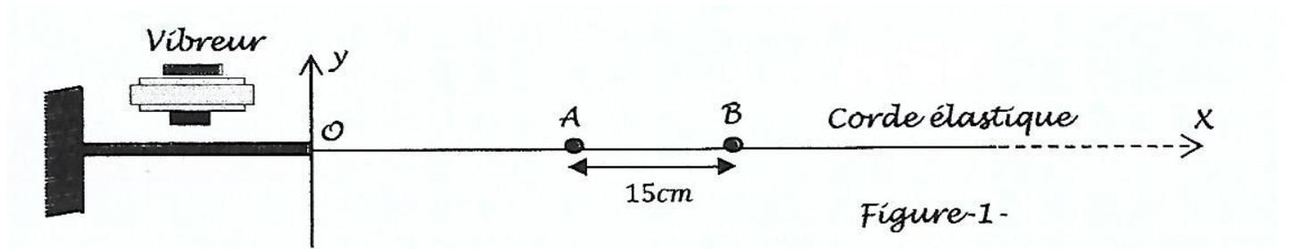
Une lame vibrante communique à l'extrémités d'une corde élastique homogène tendue horizontalement, un mouvement vibratoire transversal, sinusoïdal d'amplitude  $a$  et de fréquence  $N$ . Le mouvement de la source  $S$  débute à l'instant  $t = 0$ , à partir de sa position d'équilibre prise comme origine des elongations  $y$ . On néglige toute réflexion et tout amortissement de l'onde.
