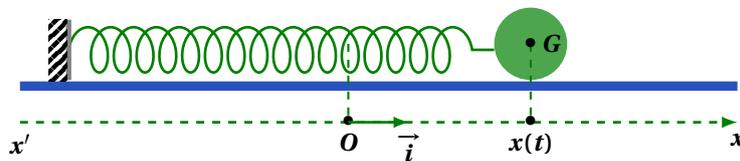
Un pendule élastique est constitué d'un solide ( $S$ ) de masse  $m$  pouvant coulisser, sans frottement, sur une tige horizontale ( $T$ ) et d'un ressort, à spires non jointives, de masse négligeable et de constante de raideur  $k$ .
