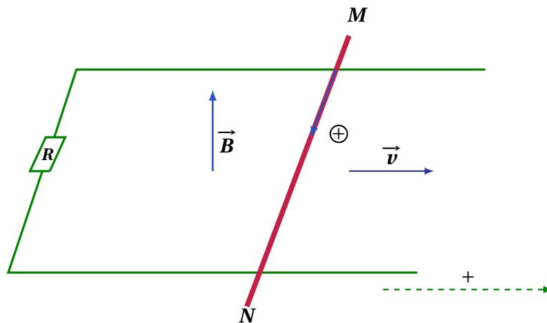
Deux rails parallèles distants de  $a$  définissent un plan horizontal. Sur ces rails se déplace sans frottement un conducteur  $MN$  de masse  $m$  perpendiculaire à la direction des rails. L'ensemble est plongé dans un champ magnétique  $\vec{B}$  uniforme vertical dirigé vers le haut. Les rails sont reliés par une ré-
