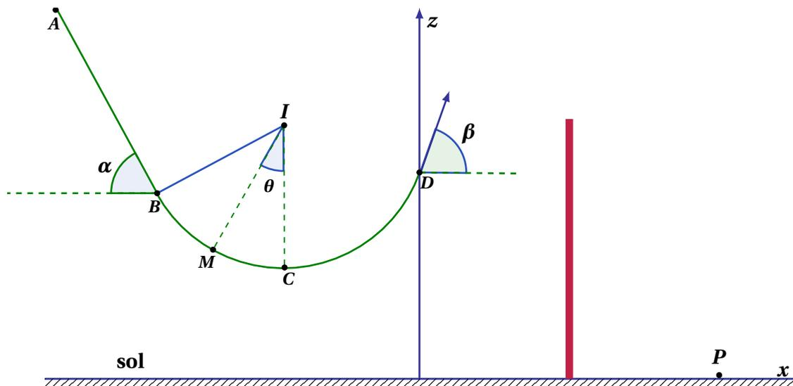
$AB$  est un plan incliné d'un angle  $\alpha = 30^\circ$  par rapport à l'horizontale. On donne  $AB = 1,6 \text{ m}$ .
